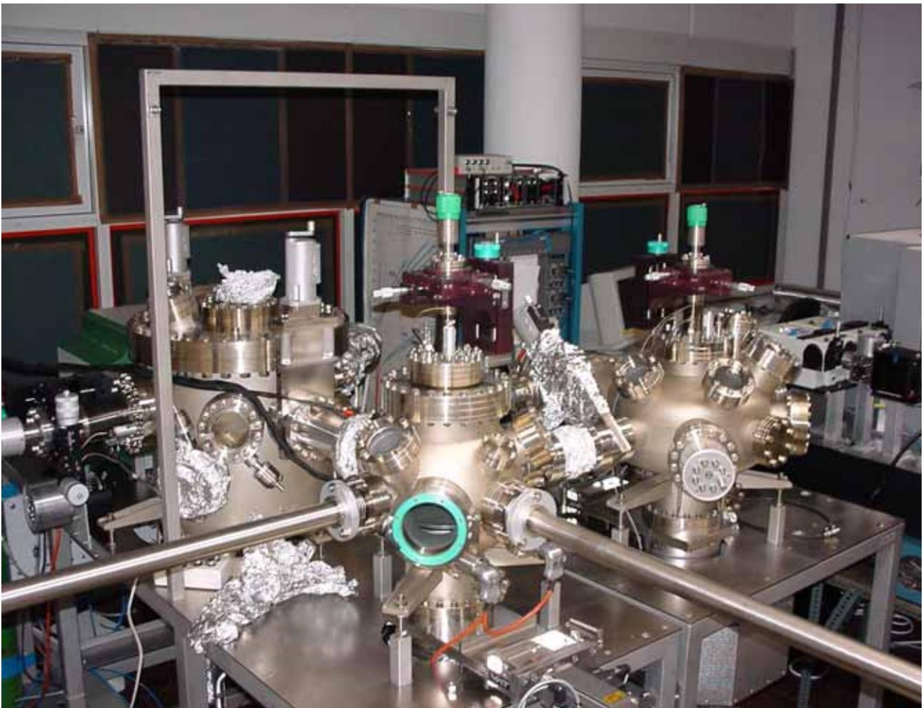
*Abbildung 3.1:* Die Abbildung zeigt die MBE-Anlage, an der die Experimente durchgeführt wurden. Im Vordergrund ist die Schleusenkammer sichtbar, links von ihr die Wachstumskammer und rechts die Analysechamber.
